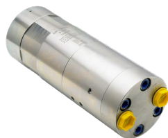
MPL-4000: montáž do vedení Pvstup: 30 - 207 barů Pvýstup: 4 000 barů Qvstup max.: 30 l/min
