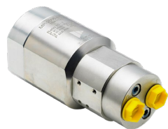
MP-2000: montáž do vedení Pvstup: 30 - 207 barů Pvýstup: 200 - 3 000 barů Qvstup max.: 13 l/min
