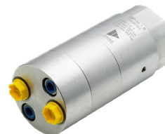
MP-M: montáž do vedení Pvstup: 15 - 207 barů Pvýstup: 30 - 800 barů Qvstup max.: 35 l/min
