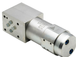
MP-C: CETOP/NG6 montáž Pvstup: 15 - 207 barů Pvýstup: 30 - 500 barů Qvstup max.: 15 l/min
