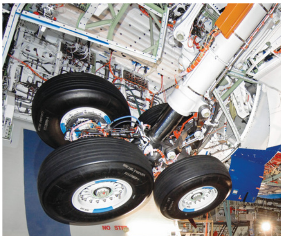
Testování podvozků letadel... (A380 @12 mil. cyklů)
