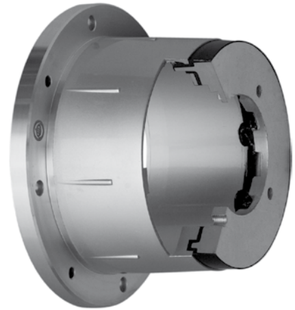
Obr. 4 Příruba čerpadla Monobloc, tlumené, dle VDMA 24 561, tvarové spojení bez šroubů
