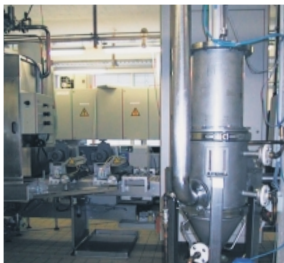
Automatický filtr Metal Edge se stěrkovým čištěním na čokoládu
