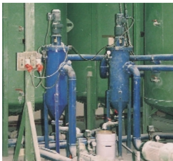
Automatický filtr Metal Edge se stěrkovým čištěním na lepidla
