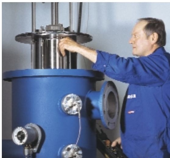
Konečná montáž speciálně vyráběných automatických filtrů MAHLE
