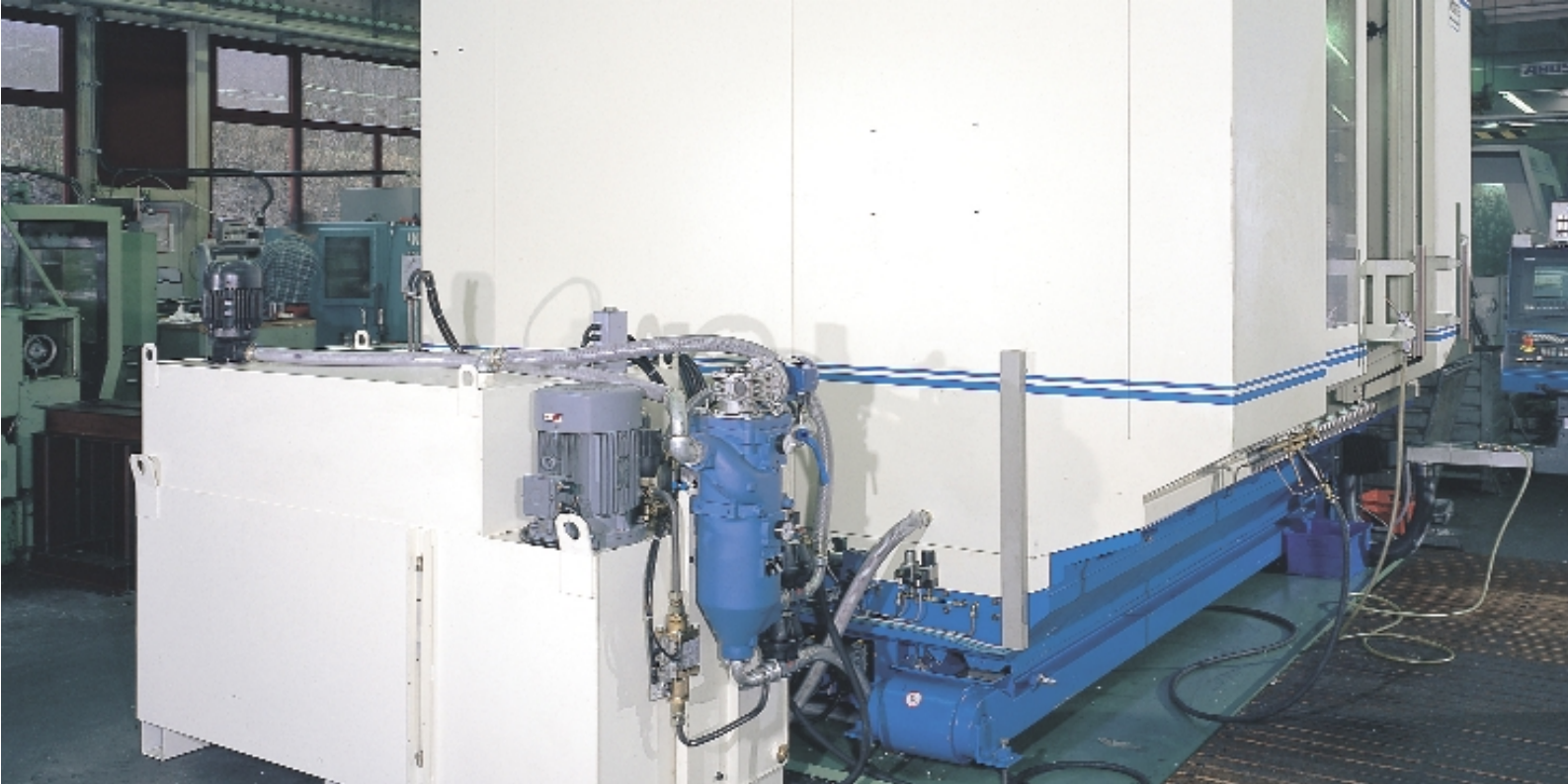
Automatický filtr chladicí emulze v obráběcím centru
