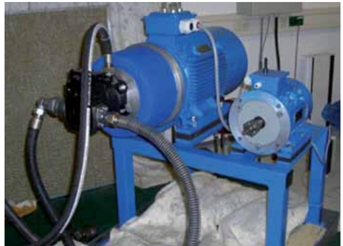
Grundplattform zur Aufnahme der Hydraulikpumpe: E-Motor (4 kW und 18,5 kW), Pumpenträger (schon mit Nachrüstkit versehen) und Pumpe.
