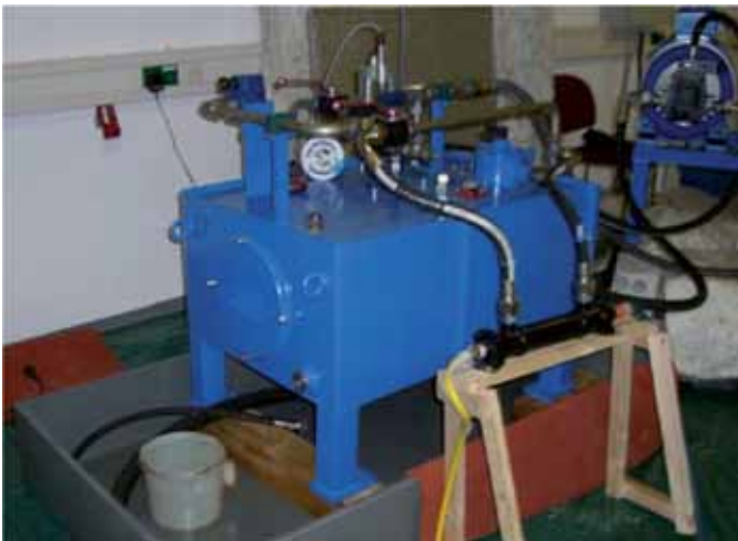
Aufbau des Hydraulikaggregats mit Tank, Ölwanne und Drosselventil
