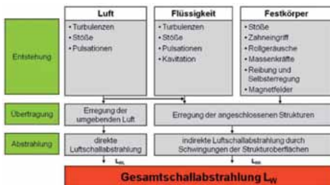
Modell der Schallerzeugung – Geräuschmechanismus (aus VDI 3720)
